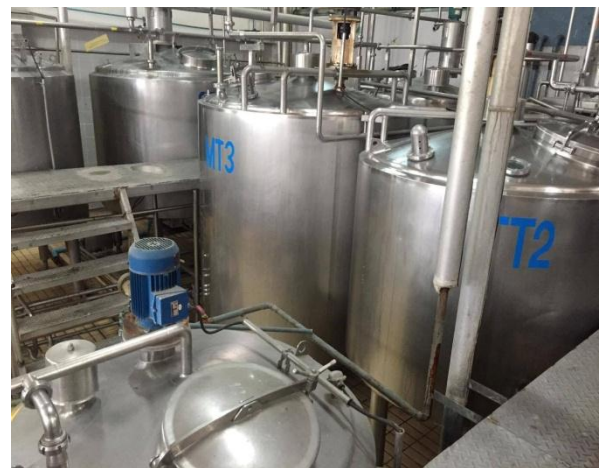
รูปที่ 1 ถังหมักนม (2 ถัง) ถังผสม (2 ถัง) และถังน้ำเชื่อม (1 ถัง) อุปกรณ์สำหรับผลิตนมเปรี้ยวของ
